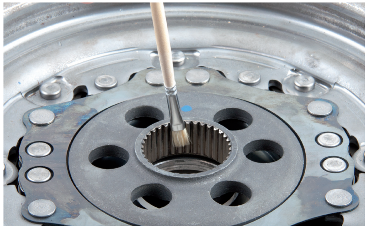
Fig. 1: El engranaje interno del ZMS debe engrasarse ligeramente tras cada reparación
