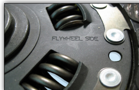
Fig. 1-4: posibles inscripciones sobre el disco de embrague.
