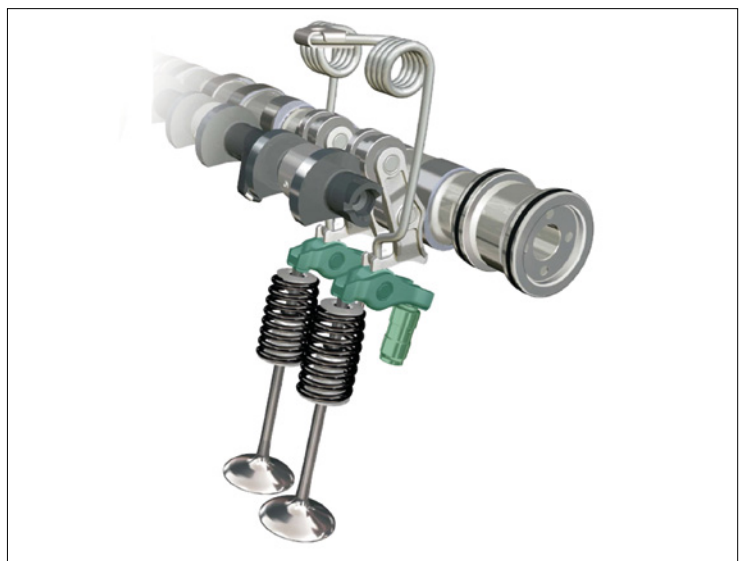
Figura 1: Vista general del motor Valvetronic de BMW
